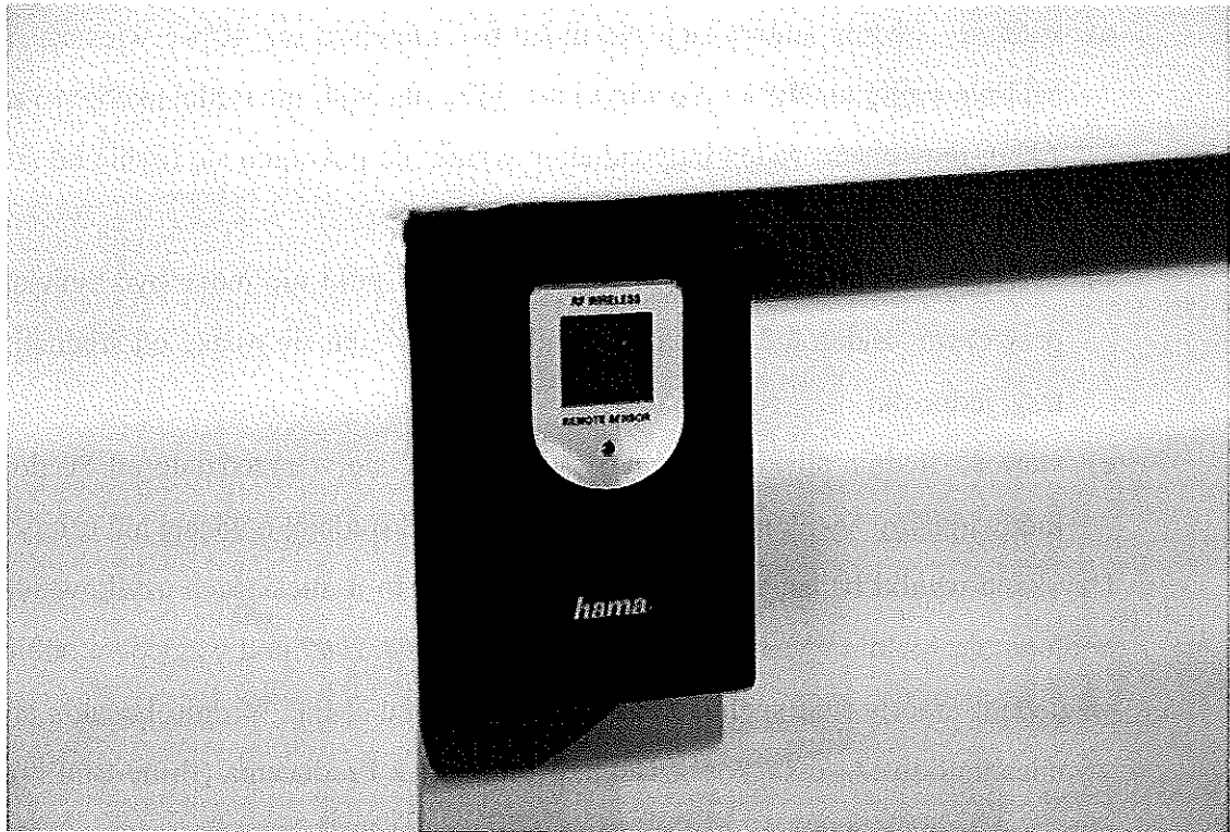
Fot. 9 Zamontowany w hali termohigrometr
